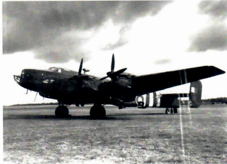
Die Spannweite eines Halifax MV Rolls Royce Merlin Engines beträgt 99 Fuß. Dies ist fast identisch mit einer Lancaster, aber das Flugzeug bildet ein "H", während eine Lancaster ein "L" bildet
